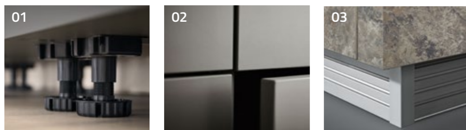
01. De positie van de plintpoten kan indien nodig worden aangepast. Hoogteverstelling +18/-10 mm. 02. Bijzonder smal voegenbeeld. 03. Lamellenplint – ventilatie voor inbouwapparaten als werkbladafzuiging. Aluminium of zwart.
